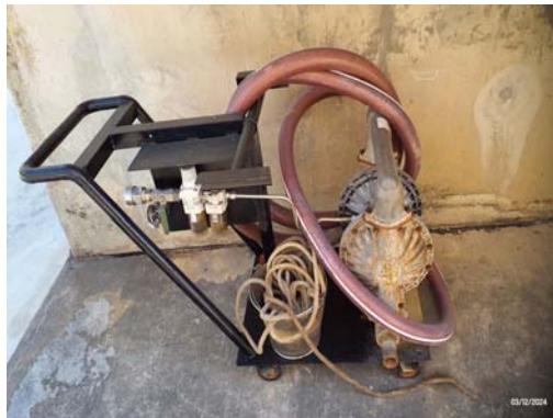
รูปที่ 3.2-17 Diaphragm Pump
