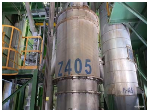
รูปที่ 3.2-6 ระบบดักฝุ่นแบบถุงกรอง (Bag Filter) (M-405)
